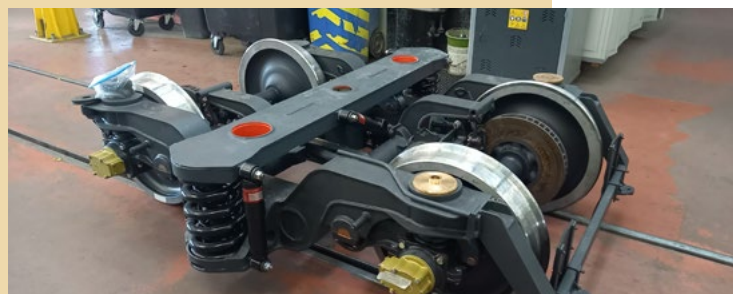
Essieu révisé d'un bogie transporteur
